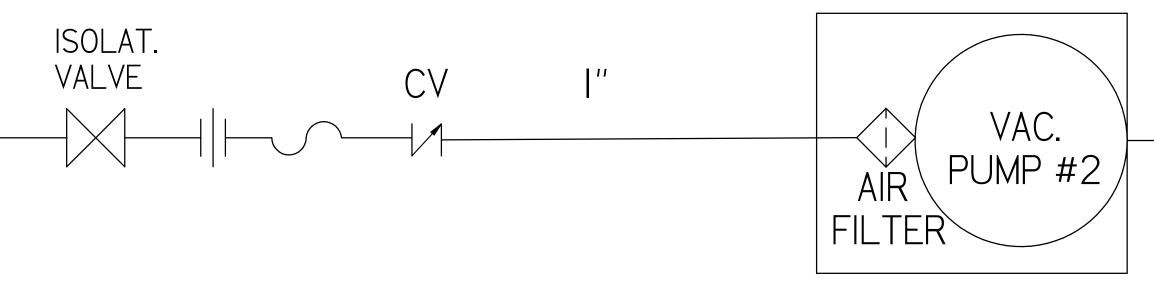
NOTE: A 1/4 INCH VENT PLUG IS LOCATED IN THE FILTER HOUSING
